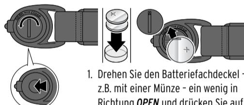
1. Drehen Sie den Batteriefachdeckel - z.B. mit einer Münze - ein wenig in Richtung **OPEN** und drücken Sie auf den Ein-/Ausschalter auf der Oberseite, um den Deckel abzunehmen.
