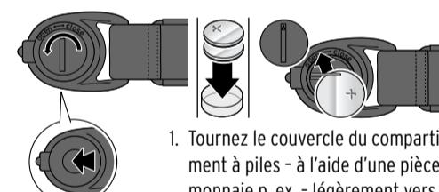
1. Tournez le couvercle du compartiment à piles - à l'aide d'une pièce de monnaie p. ex. - légèrement vers **OPEN** et appuyez sur l'interrupteur marche/arrêt sur la face supérieure pour retirer le couvercle.
